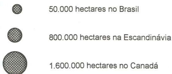
Fig. 02 - Área de florestas requeridas para suprir uma fábrica de celulose branqueada de 500.000 toneladas/ano (Fonte: Adhemar Villela Filho, "Uma visão Estratégica do Suprimento de madeiras do setor Florestal" 1995, pp. 10)
